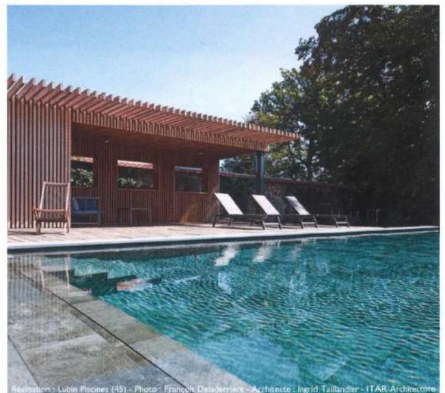
Piscine en béton armé semi-enterrée - revêtement carrelage Rosa Grès Bohème Nuit 30 x 60 cm - désinfection automatisée au brome - couverture immergée.
